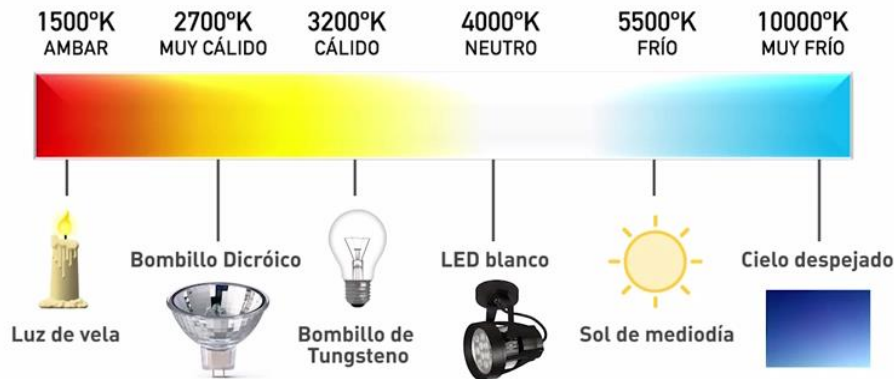
Figura 12. Escala de temperaturas de color (K) y ejemplos de fuentes de luz.
