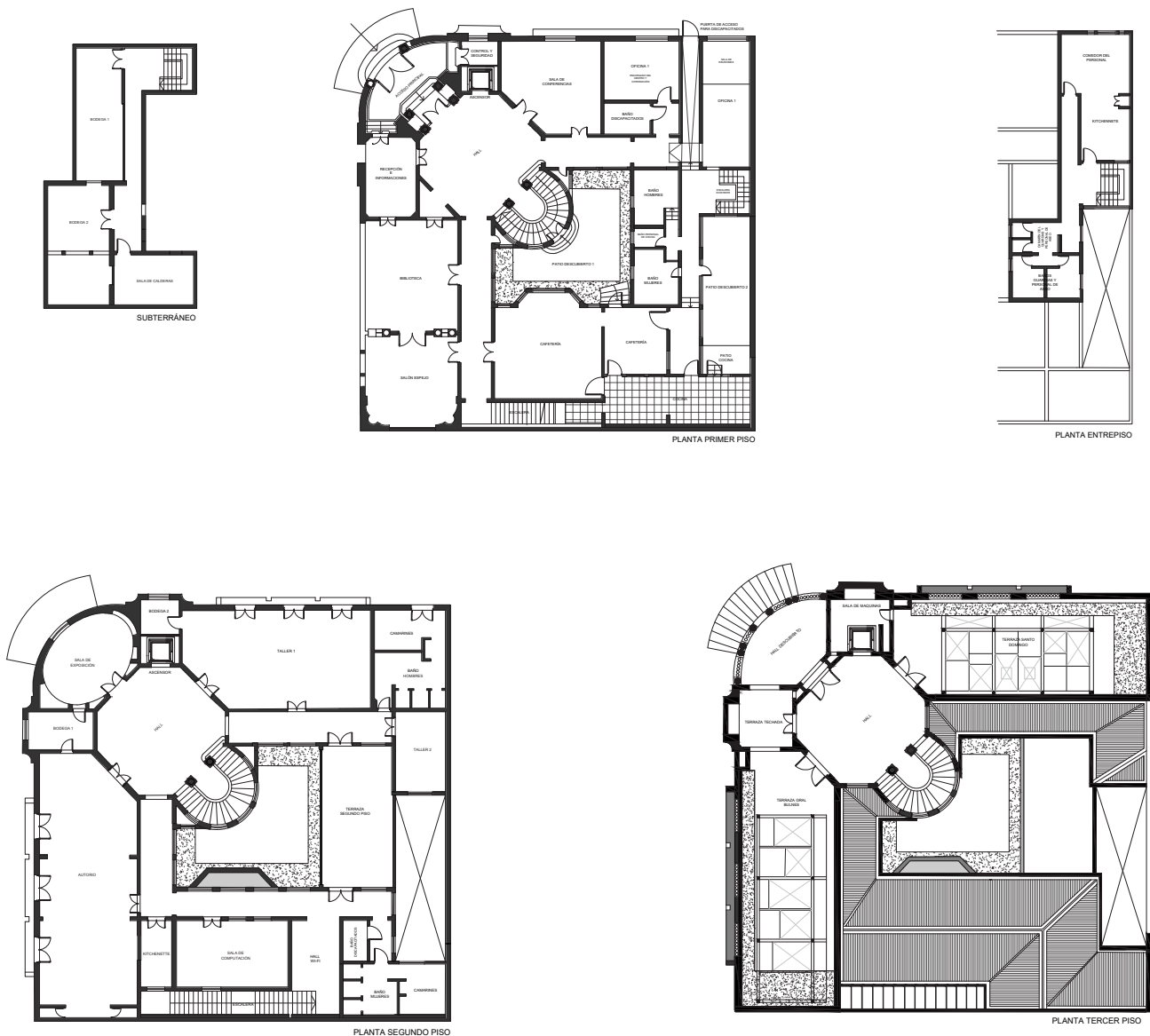
Figura 69. Planimetrías elaborada en base a las intervenciones que se le han realizado al inmueble a lo largo de los años. Elaboración propia, 2022
