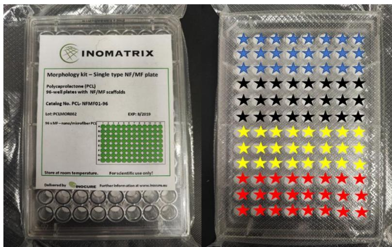
**Figura 23:** Ejemplo, Placa 1 (100PCL): 24 muestras de “Malla 1” (estrellas azules), 24 muestras de “Malla 4” (estrellas negras), 24 muestras de “Malla 7” (estrellas amarillas), 24 muestras de “Malla 10” (estrellas rojas).
