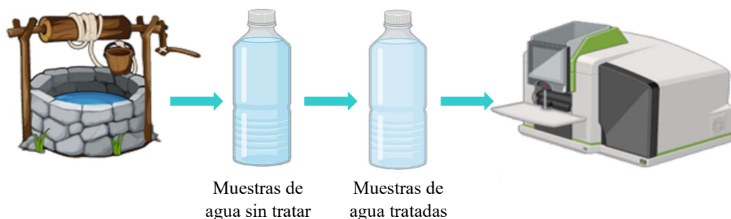
Figura 4: Diagrama proceso de determinación de arsénico en agua subterránea. Se tomaron muestras de agua de 7 pozos, las cuales fueron sometidas a un pretratamiento con ácido nítrico al 10 % para posteriormente medir la concentración de arsénico utilizando espectrofotometría atómica con liberación de hidruros.
