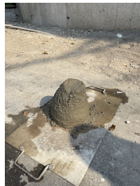
Figura 2.4: Ensayo de Cono de Abrams en Obra. Fuente: Elaboración Propia.
