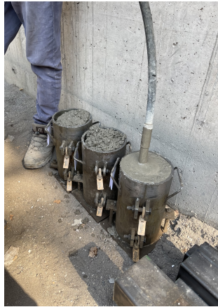
Figura 2.12: Probetas Fabricadas en Obra a Partir de Hormigón Premezclado. Fuente: Elaboración Propia.
