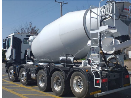
Figura 2.1: Camión Mixer Renault Truck C460 - 10M Liebherr. Fuente: Catálogo Salfa Camiones.
