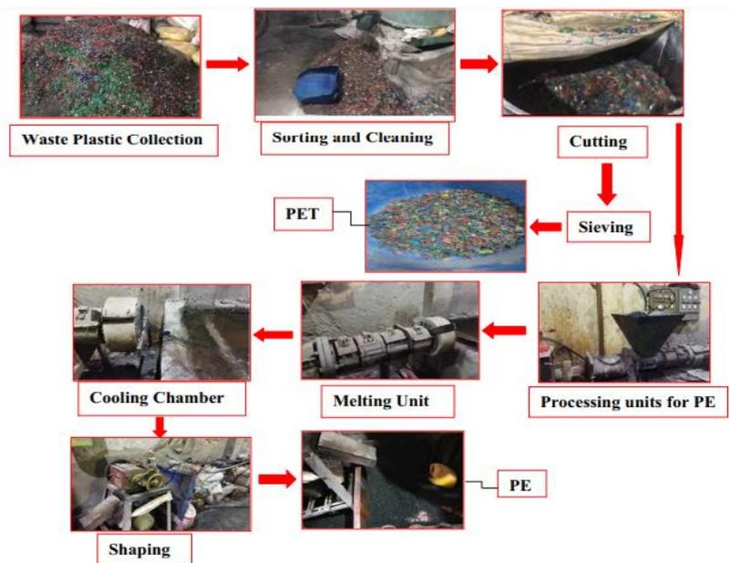
Ilustración 19: Proceso de reciclaje PET y PE (Sau, Shiuly, & Hazra, 2023).
