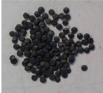
Figura 5.7: Formato de plásticos reciclados adicionados a mezcla asfáltica. Fuente: (Cauhape, y otros, 2021)
