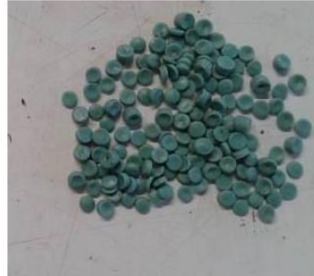
Figura 5.7: Formato de plásticos reciclados adicionados a mezcla asfáltica. Fuente: (Cauhape, y otros, 2021)
