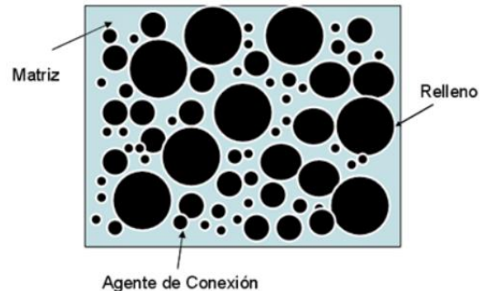
Figura 6. Componentes fundamentales de la resina compuesta. Esquema general donde puede verse la matriz orgánica, las partículas de relleno y el agente de conexión.
