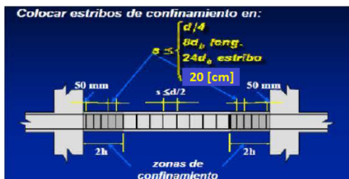
Figura 6.26: Condiciones de diseño posicionamiento estribos viga
