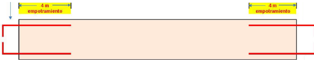
Figura 6.18: Extensión empotramiento armadura longitudinal pasiva vigas
