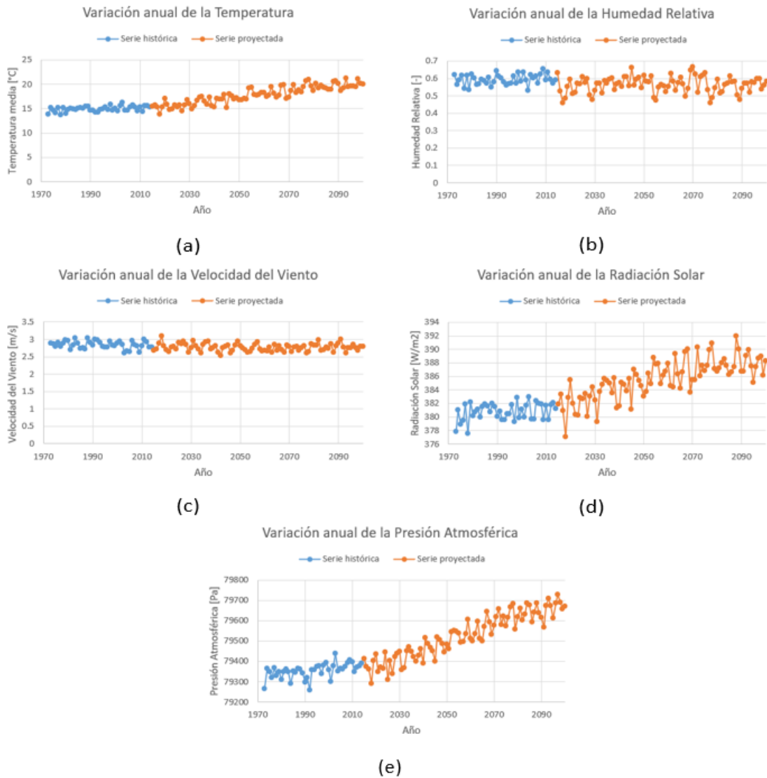
Figura B. 2: Variación del promedio anual de la temperatura media (a), humedad relativa (b), velocidad del viento (c), radiación solar (d) y presión atmosférica (e) según el Modelo de Circulación General AWI-CM-1-1-MR. La línea azul representa los datos históricos del modelo, mientras que la línea naranja muestra las proyecciones del escenario SSP5-8.5.
