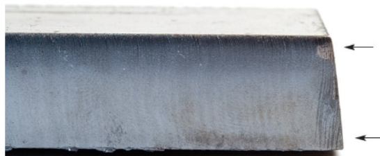
Figura 2.8: Pieza cortada en plasma, bordes irregularidades.
