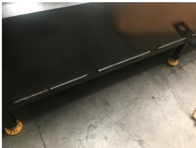
Figura 6.12: Mesa de agua soldada en puntos de unión.
