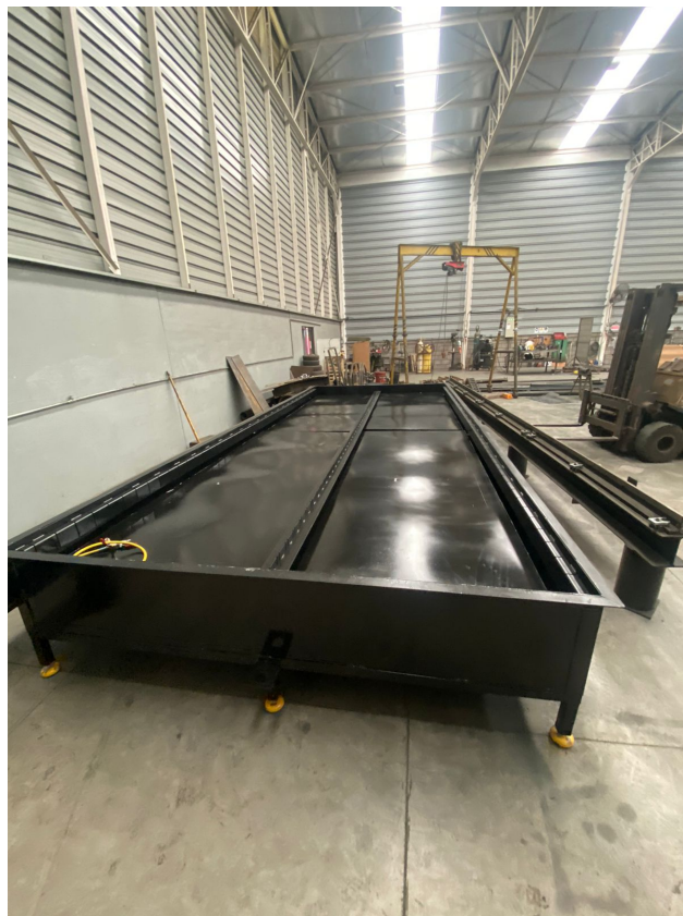
Figura 6.10: Mesa pintada con con esmalte sintético para metales.
