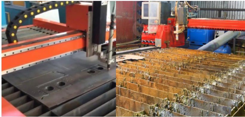
Figura 2.4: Barras de corte nuevas y gastadas.
