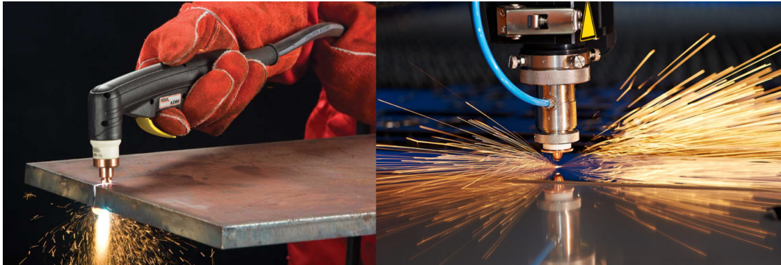
Figura 2.3: Corte por plasma manual (izquierda) y CNC (derecha) [10].
