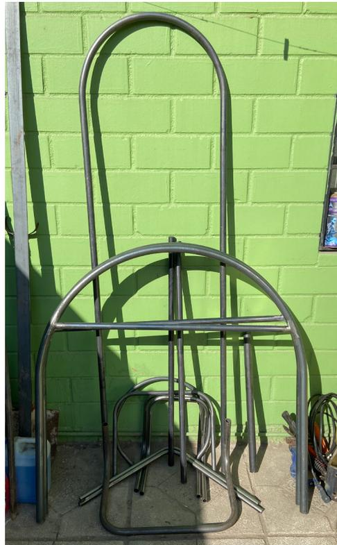
fig. 408, 409, 410, 411 y 412: Piezas de la silla para su tapizado por Jorge de “Tapicería Anahis”, y piezas tubulares de fierro ya curvadas. Elementos necesarios para iniciar la construcción del Prototipo Final. Elaboración propia.
