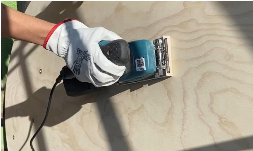
fig. 447 y 448: Lijas para madera de grano 80, 150 y 400, lijadora y proceso de lijado de la base, que se repitió en las demás piezas de madera. Elaboración propia.
