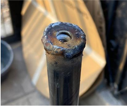
fig. 432, 433 y 434: Preensamble de la estructura interna y externa de la base. Partes soldadas con un "hilo" interno y perforación de la estructura visible, piezas que serán aseguradas mediante pernos. Elaboración propia.
