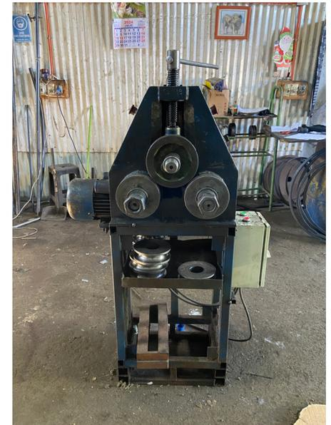
fig. 405, 406 y 407: Espacio de trabajo de "Cilindrados y Curvados", y máquinas utilizadas por Edilio para el curvado de los tubos. Elaboración propia.
