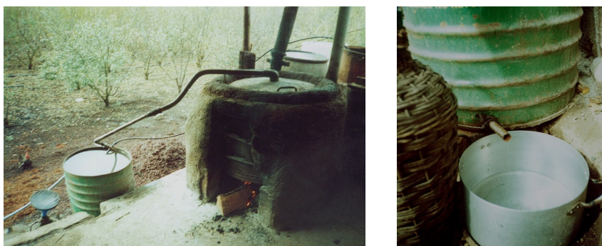
109 y 110. Producción de aguardiente con fondo de cobre y alambique en espiral.
