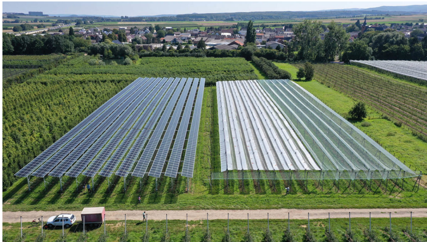
Figura 2.10: Proyecto agrivoltaico en Alemania, lado a lado con protección climática mediante cubiertas plásticas. Fuente: [67].
