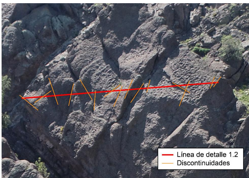
Figura 34: Ejemplo de identificación de discontinuidades en una línea de detalle
