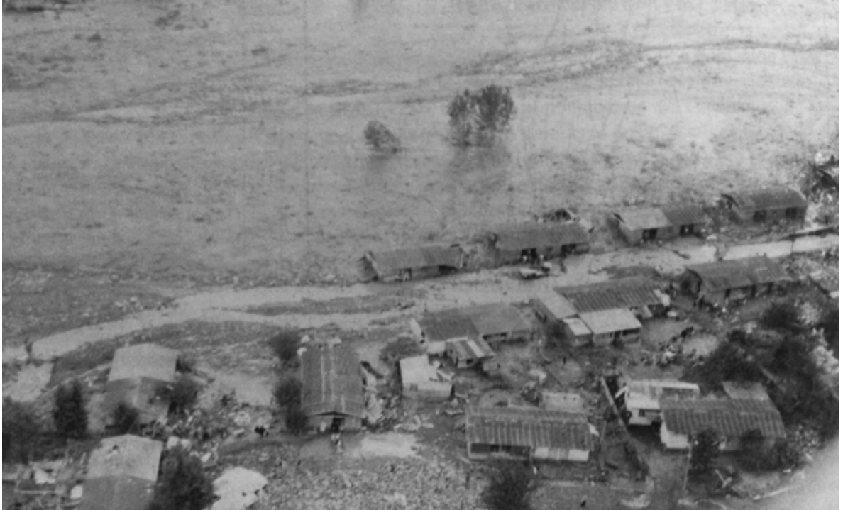
Fig. 8 : Población Fernando Domínguez après les coulées de boue de 1993. On note la fragilité des constructions et leur position de vulnérabilité le long du lit de la ravine Macul (au centre, où on distingue un arbre). Source : Corvalan et al. , 1997.
