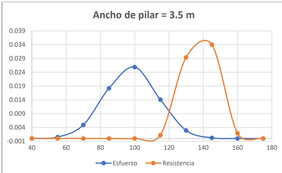
**Figura 11: Esfuerzo y resistencia del pilar-Ancho de pilar=3.5m.**
