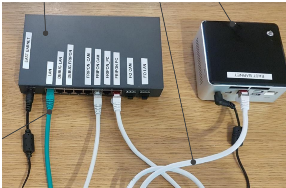
Figura 2.6: Diagrama de conexión de componentes de la estación FRIPON.
