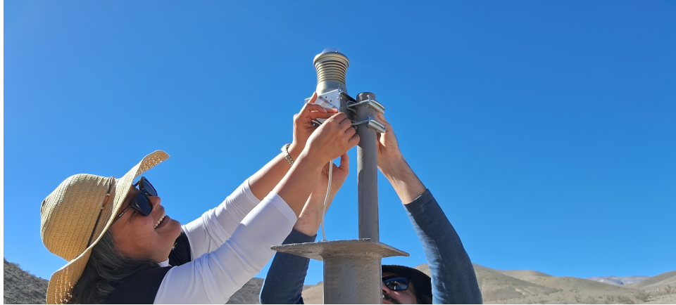
Figura 2.22: Instalación de la cámara FRIPON de la estación Tierra Amarilla.
