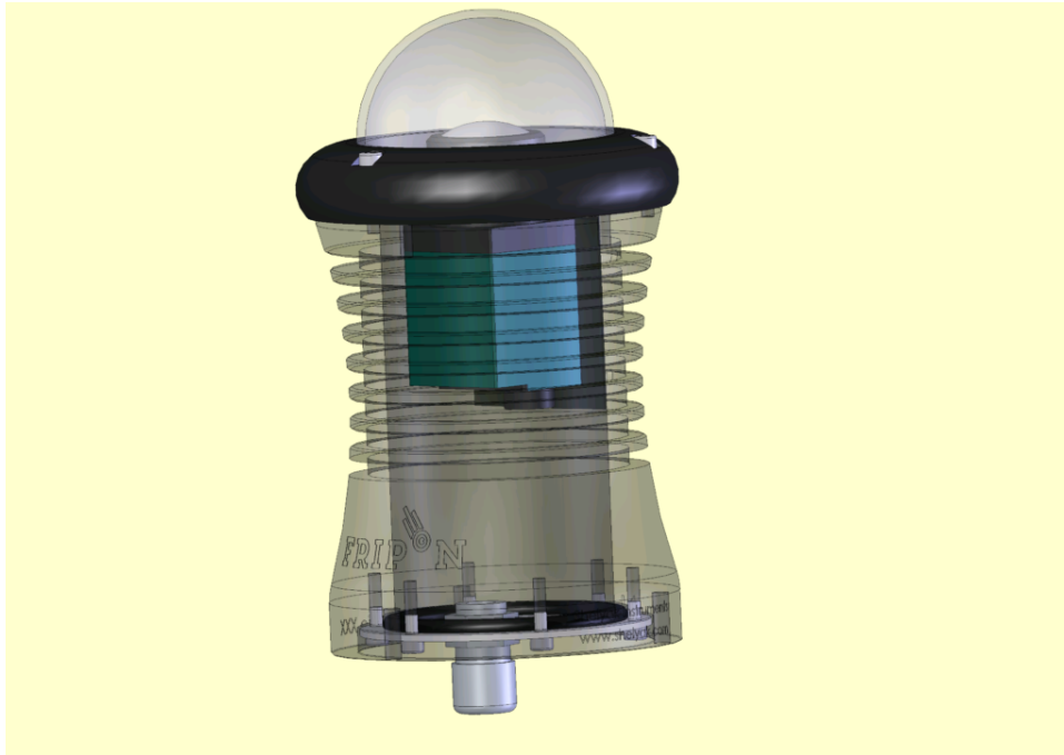
Figura 2.5: Estructura interna de una cámara FRIPON [5].
