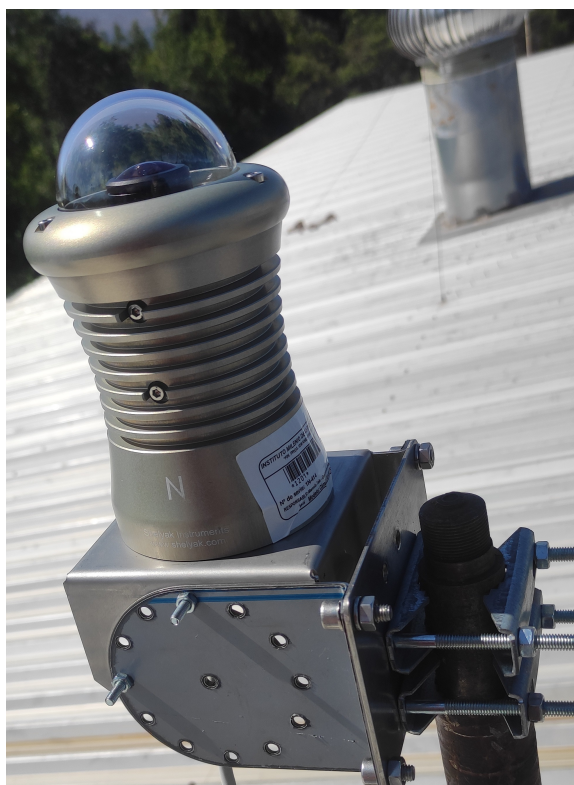
Figura 2.16: Cámara FRIPON perteneciente a la estación instalada en Cerro Calán, región metropolitana.
