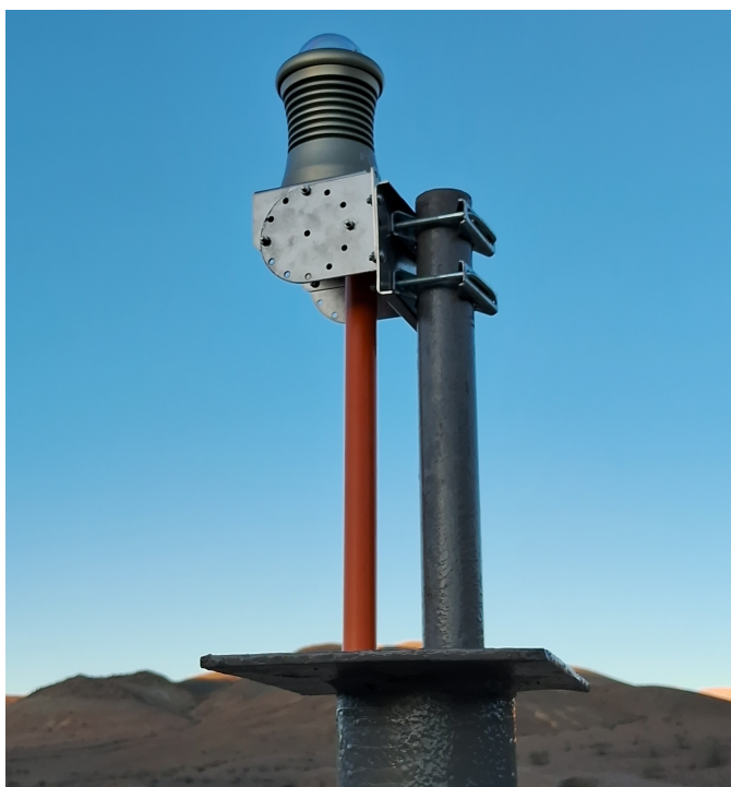
Figura 2.8: Cámara fijada en un asta (estación de Tierra Amarilla).
