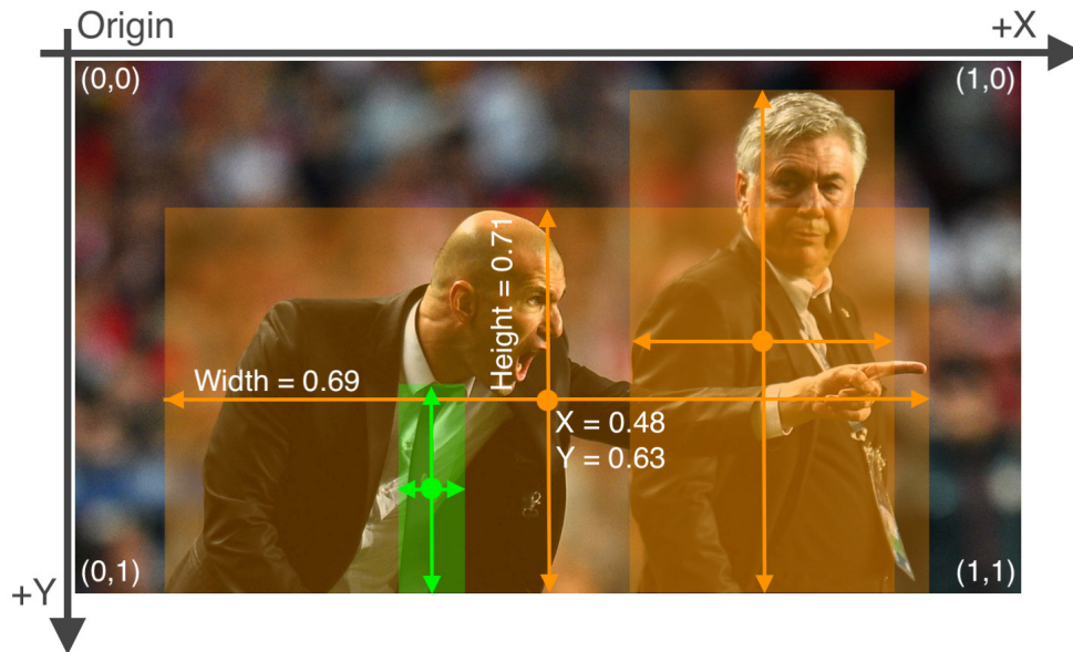
Figura 4.4: Ejemplo visual del formato YOLO en imagen. Imagen obtenida de [47].
