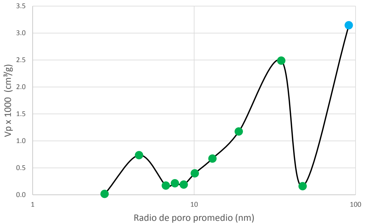
Figura 32: Volumen parcial de poros en función del radio de poro promedio de Muestra 2.3.
