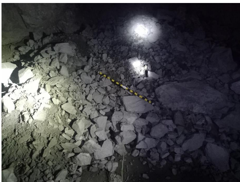
Figura 21: Material post tronadura de tronadura de desarrollo con Emulsión.
