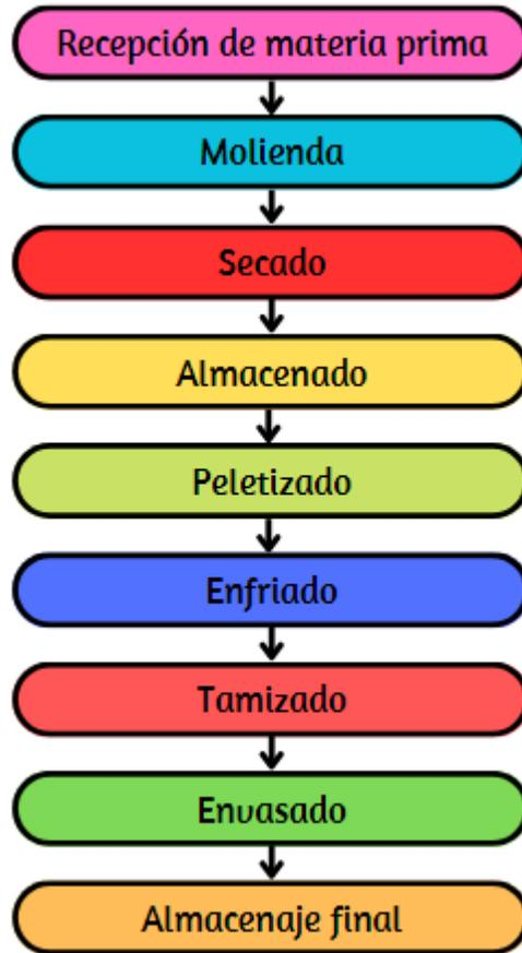
Figura 4.6: Proceso de producción de pellets de espinillo.
