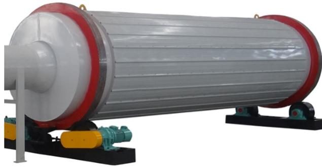
Figura 4.10: Secador rotatorio de tres capas [19].
