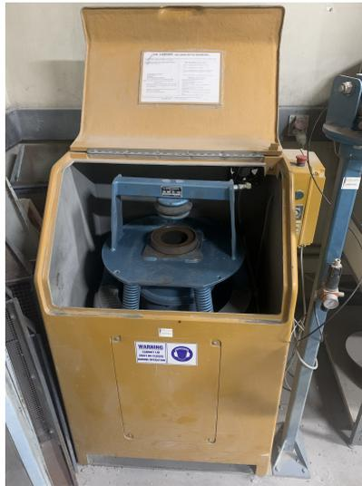
Figura 3.8: Molino pulverizador.
