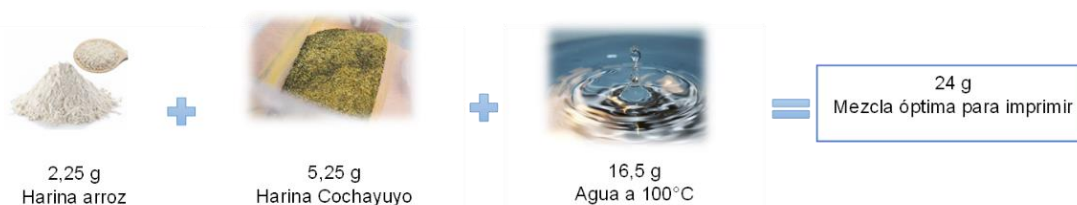
Figura 11. Formulación óptima mezcla impresión 3D
