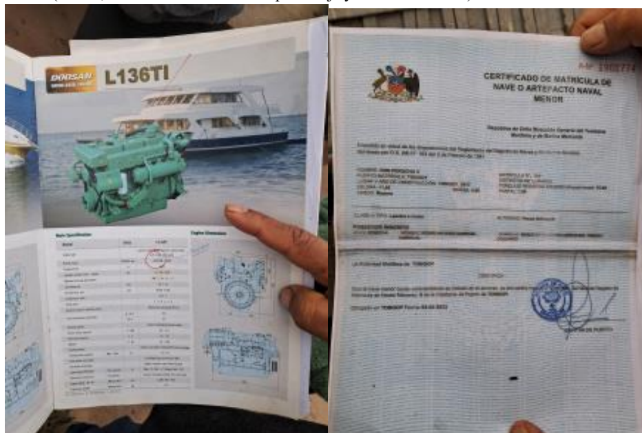
Detalles del motor (entregado por el gobierno después del terremoto) Detalles registrados de la lancha vista. (Esolora: 11.98 m, Manga: 4.93 m, Puntal: 1,83 m)
