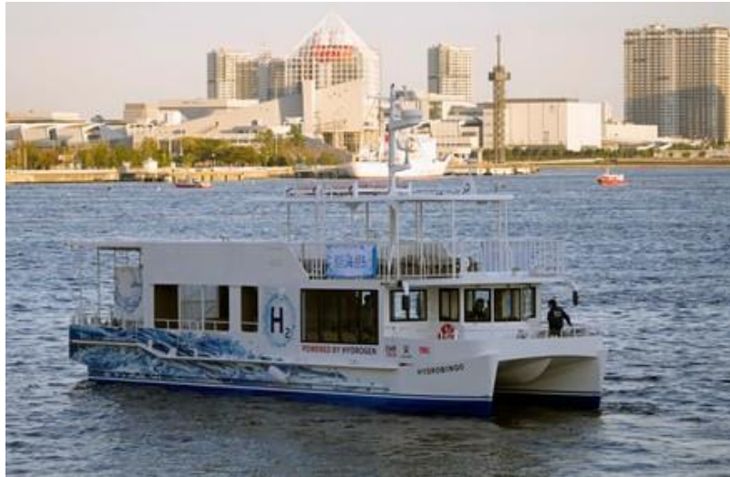
Figura 15. Volvo Penta. (2023, junio). HydroBingo. En Volvo Penta y CMB.Tech colaboran para alimentar el primer ferry comercial impulsado por hidrógeno del mundo . Recuperado de https://www.volvopenta.com/about-us/news-page/2023/jun/volvo-penta-and-cmb-tech-collaborate-to-power-the-worlds-first-hydrogen-fueled-commercial-ferry/
