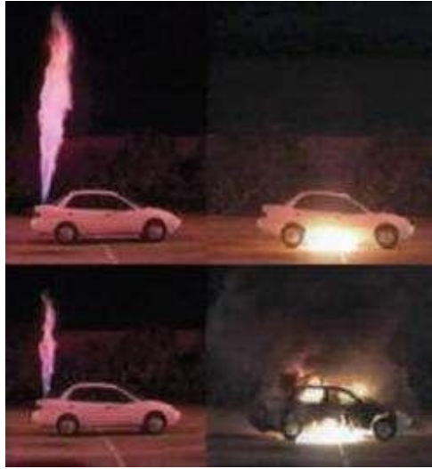
Figura 6. Dr. Michael R. Swain, Universidad de Miami, 2001, experimento de fuga de combustibles (hidrógeno comprimido con un sistema de seguridad a la izquierda, auto a gasolina a la derecha)
