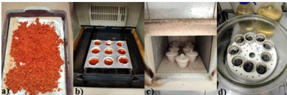
Figura 4. Etapas de la síntesis del carbón activo a) Molienda b) Activación c) Pirólisis d) Lavado.
