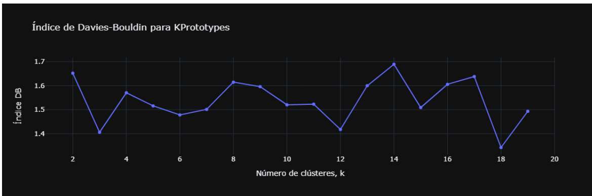
Figura 6.2: Índice de Davies-Bouldin según la cantidad k de grupos para el algoritmo k -prototypes.
