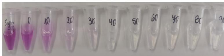
Figura C.2: Fotografía del contaminante (3 y 5 ppm) con su indicador (difenilcarbazida).
