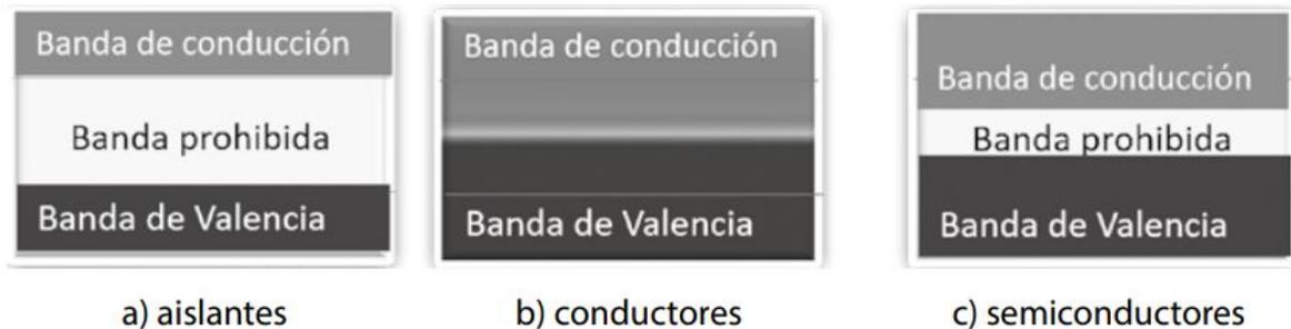
Figura 1.10: Esquema para representar las bandas de energía. a) aislantes: cuando  $E_g$  es mayor a 4 eV. b) conductor: cuando  $E_g$  es igual a 0 eV. c) semiconductor: cuando  $E_g$  es menor a 4 eV. [19]
