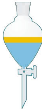
Figura 2.8: Embudo de decantación con AE e hidrolato [34].
