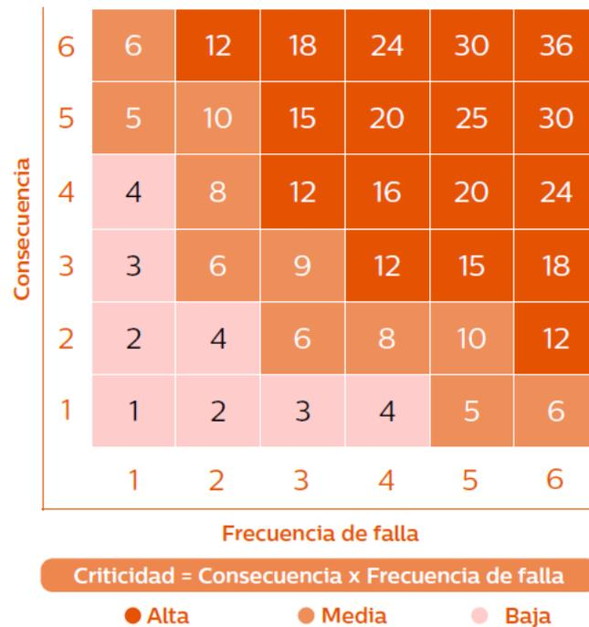
Figura 2.5: Tabla de criticidad por la consecuencia de una falla y su frecuencia de ocurrencia. Fuente (Codelco, 2022).
