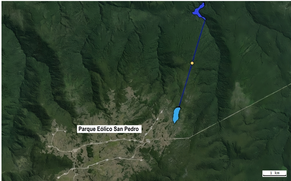
Figura 5.1: Disposición de los reservorios de la central. Fuente: RE100 Group, Australian National University.
