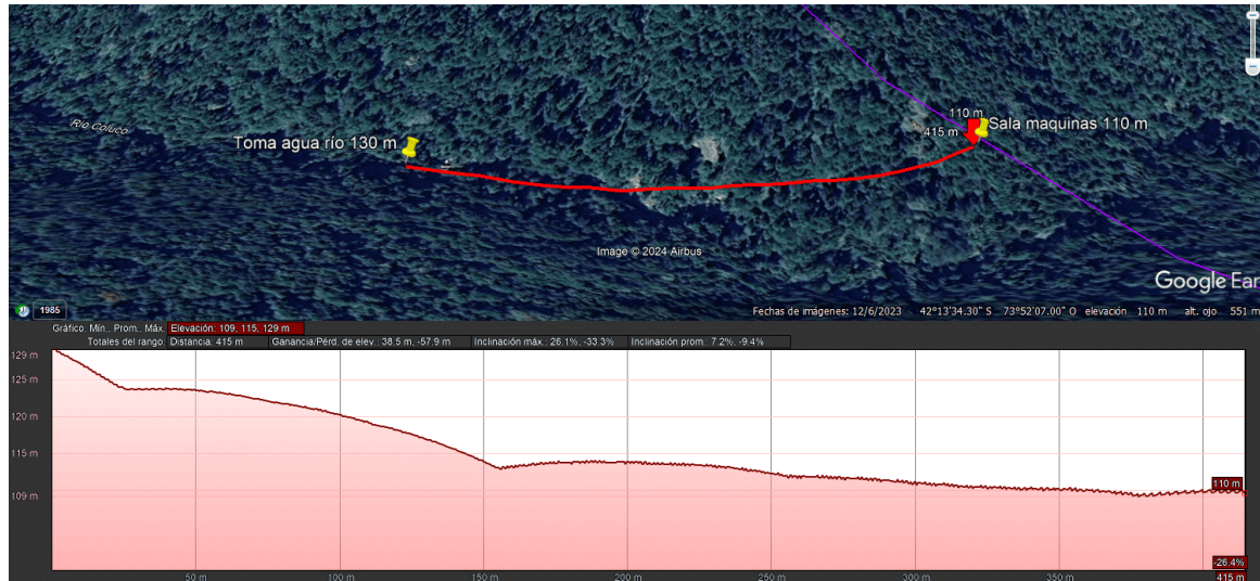
Figura 5.4: Disposición de las tuberías de succión para la central, con su perfil de elevación. Fuente: Google Earth Pro.
