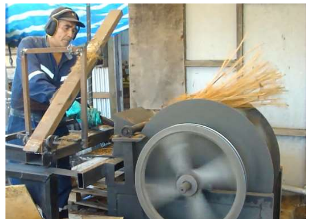
Figura 19 Peladora de mimbre mecánica. Fuente: archivo personal
