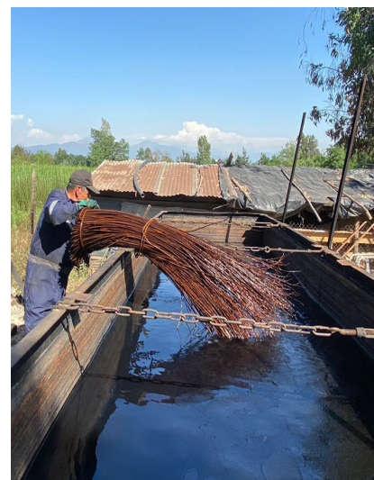
Figura 13 Piscina metálica en donde se depositan los atados de mimbre Fuente: Archivo personal
