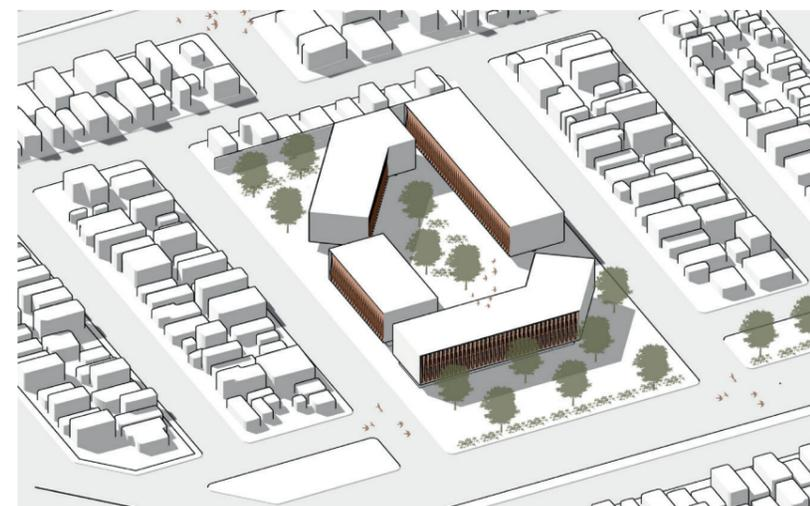
Figura 4.23: Axonométrica de propuesta preliminar en relación al control solar, aplicado para el 21 de diciembre a las 16hrs, Alto Hospicio. Elaboración propia. 2024.
