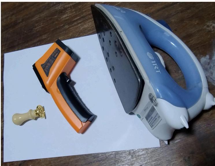
Se debe medir la temperatura de las muestras, para entender que existe una temperatura base del material y la temperatura de la superficie donde se realizó el experimento, la cual se debe mantener constante. Para ello se tomaban pausas necesarias para que al momento de aplicar el calor a las muestras y que éste se transfiera a la superficie, ésta disminuyera lo suficiente.
