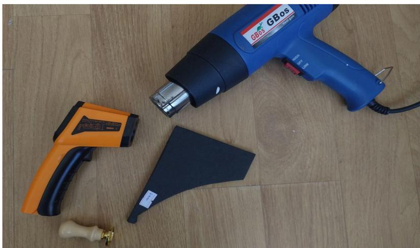
Se debe medir la temperatura de las muestras, para entender que existe una temperatura base del material y la temperatura de la superficie donde se realizó el experimento, la cual se mantuvo en 22°C, es importante mantener la temperatura de la superficie para evitar que esta afecte en el resultado del experimento. Para mantenerla se tomaban pausas necesarias para que al momento de aplicar el calor a las muestras y que éste se transfiera a la superficie, ésta disminuyera lo suficiente.
