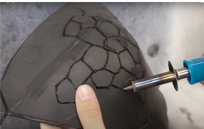
Para agregar más texturas y accesorios a la pechera, utiliza goma eva para crear unas espigas que van en la pechera, las que una parte de ellas las usa como molde para termoformar una goma eva de 2mm de grosor que recubren la mitas de estas espigas. Y se utilizó un cautín para poder trazar a pulso las escamas que recubren toda la pechera.
