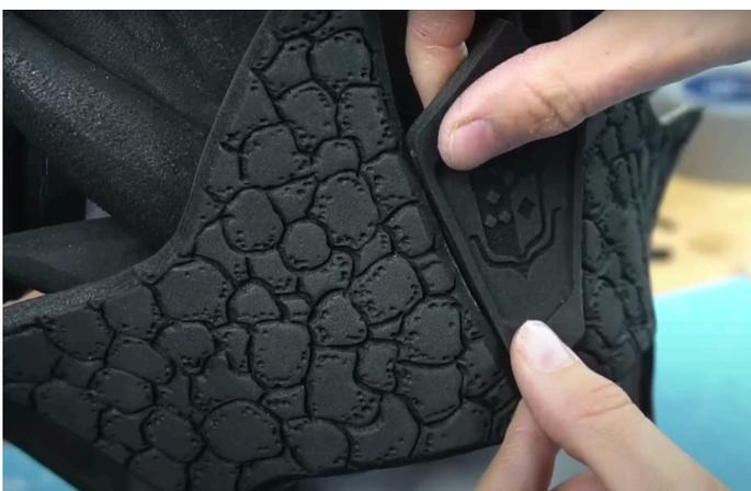
Con una cortadora láser se grabó en una pieza de goma eva un emblema, pieza que posteriormente irá puesta en el casco.
