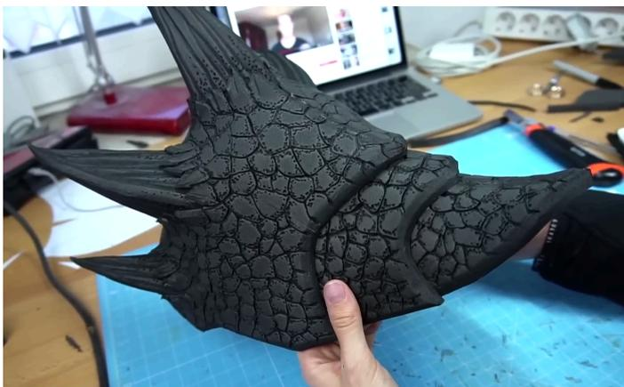
Para la segunda hombrera cubierta en espinas se utilizó goma eva moldeable para la fabricación de cada una de las espinas. Las que serían puestas una a una en una base de goma eva de 5mm utilizando un molde del hombro de Kamui.
