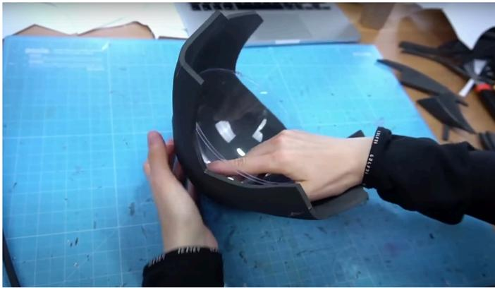
Se aplicó nuevamente el uso de una capa sobre la goma eva de 5mm para posteriormente termoformar y dar textura a las piezas.
