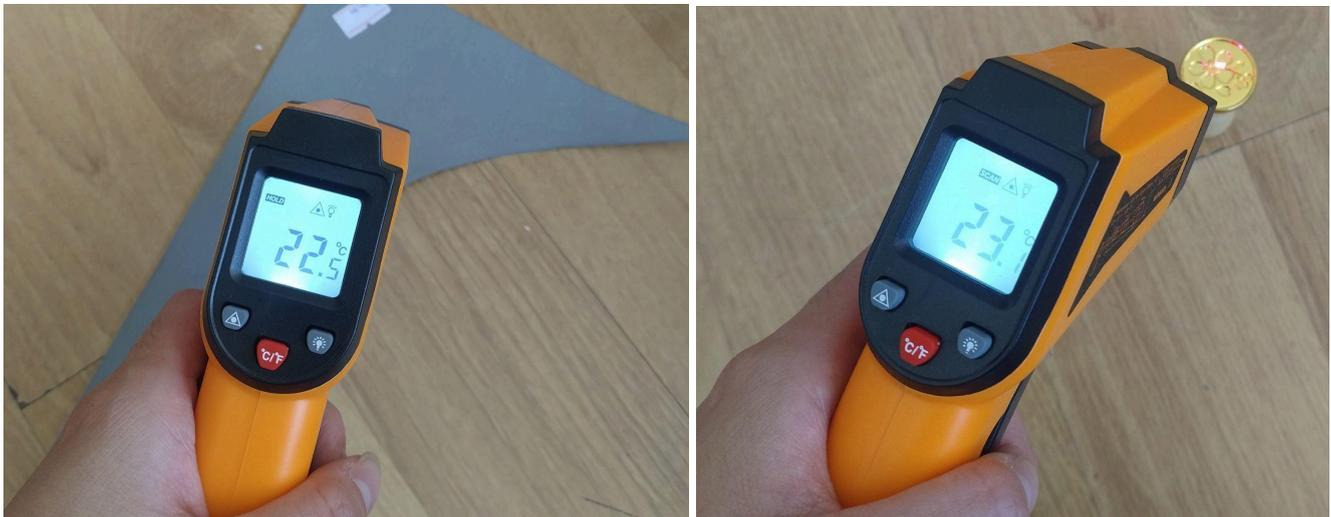
Para saber hasta qué momento la goma eva se encuentra lista para termoformar, es cuando ésta cierra sus poros y se torna ligeramente brillante. Para aplicar el calor, la pistola debe estar a 10 cm de la muestra de goma eva y el calor debe aplicarse con movimientos hacia los lados, ya que si se mantiene quieta la pistola de calor al ser tan focalizado el calor, la muestra se puede quemar antes de alcanzar su punto de termoformado.
