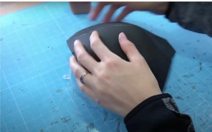
Estas piezas serán unidas con pegamento doble contacto y para conservar la forma redonda de su pecho, utilizó una pistola de calor para calentar la goma eva y una semi esfera acrilica, la que usó como molde, donde posicionó el material ya calentado y presionó con sus manos para termoformar y darle un aspecto más redondo.
