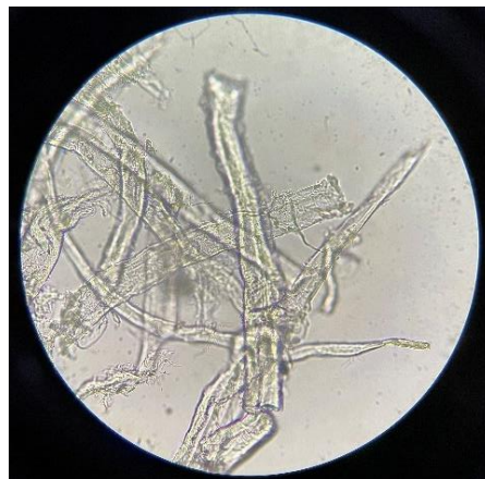
Figura 17. Muestra de fibras de papel vista en microscopio 100x.
