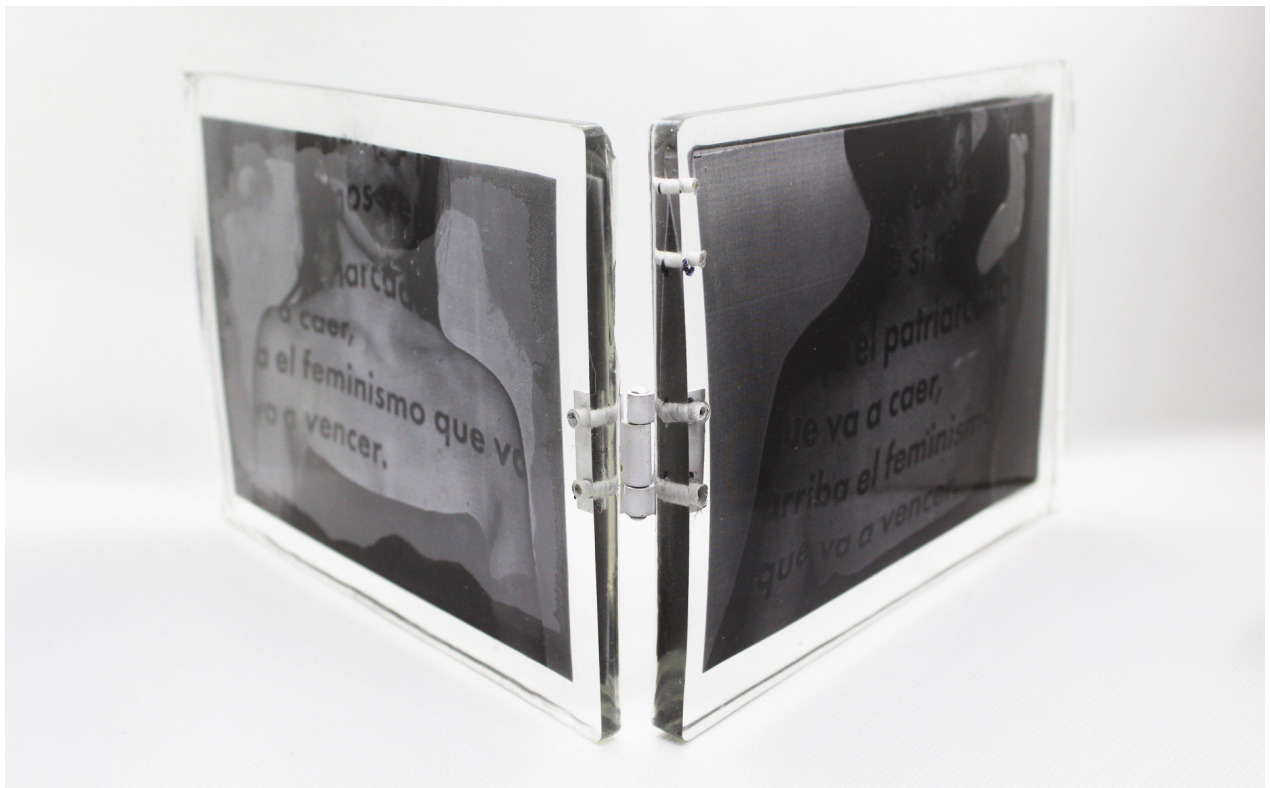
Fig. 123. Prueba de unión de las láminas de resina epóxica con bisagras.
