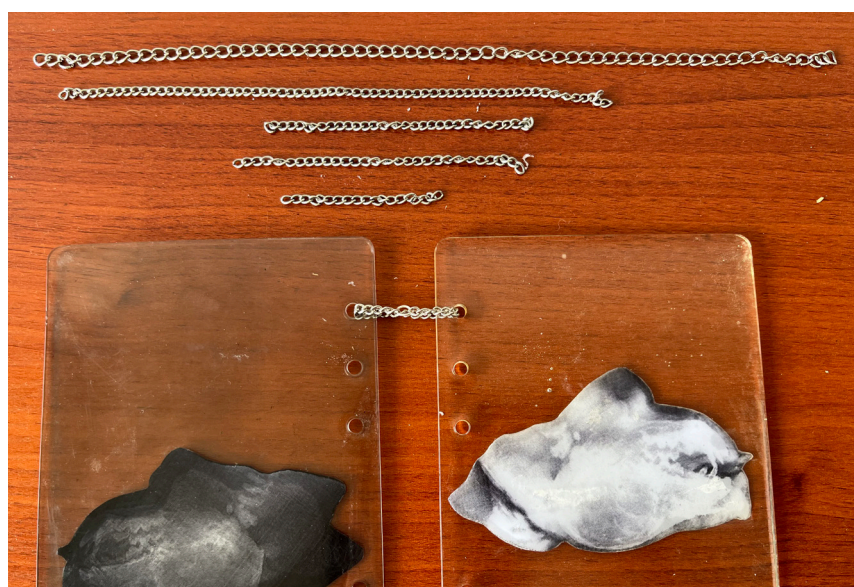
Fig. 119. Prueba de unión de la resina epóxica con distintos tamaños de cadenas.
