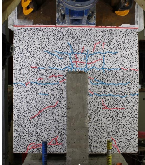
Figura 30. Avance de grietas a una rotación de 0.054 [rad].
