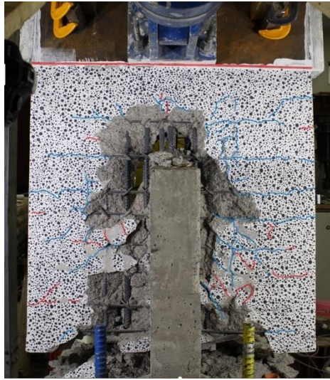
Figura 34. Avance de grietas a una rotación de 0.16 [rad].
