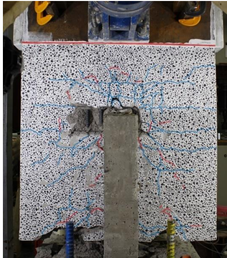
Figura 32. Avance de grietas a una rotación de 0.117 [rad].
