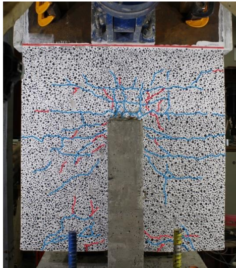
Figura 31. Avance de grietas a una rotación de 0.097 [rad].
