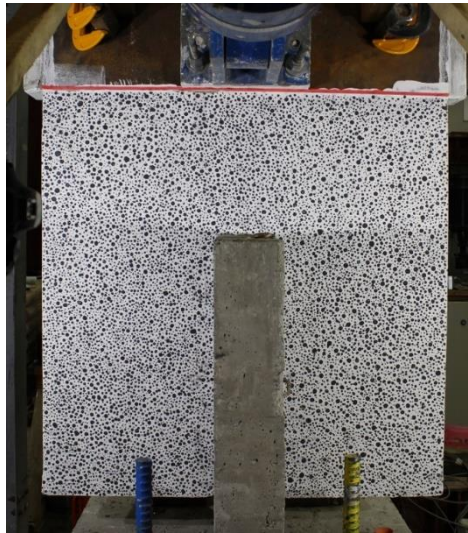
Figura 28. Cara frontal de la losa de alta cuantía previo al ensayo.
