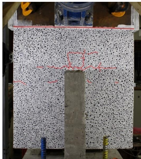
Figura 29. Primeras grietas a una rotación de 0.022 [rad].
