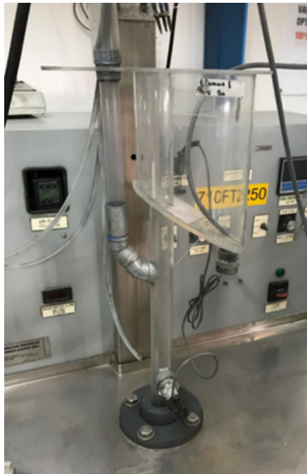
Figura 5.4: Columna de flotación con sensor de presión.
