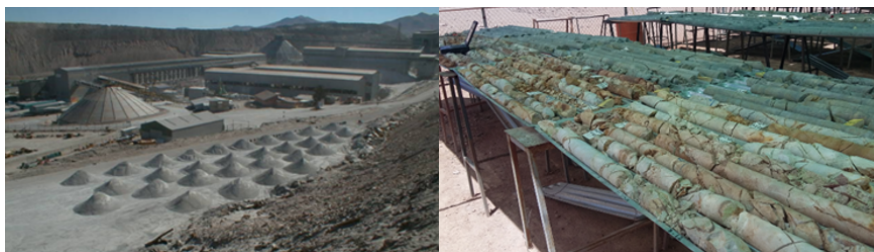
Figura 3.1: Marinas de frente de banco y sondajes a diamantina tipo PQ.
