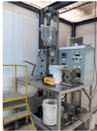
Figura 2.4: Módulos de la mini planta piloto de flotación continua.
