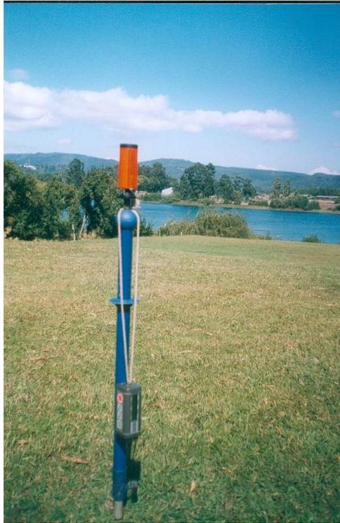
**Figura N° 10:** Vértex, instrumento utilizado en la medición de alturas.
