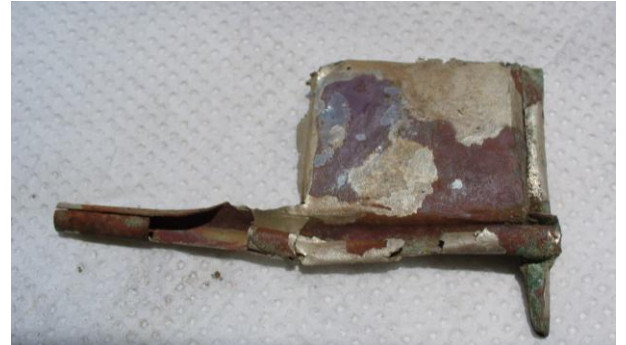
Parte posterior se observa una capa de cuprita.
