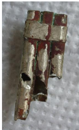
Antara. Eliminación de la cuprita de su superficie. Foto anverso y derecho.
