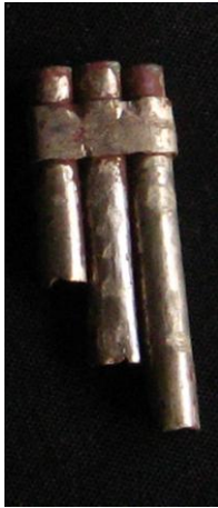
Detalle de la litera. Se puede observar los puntos de corrosión activa, cuprita.
