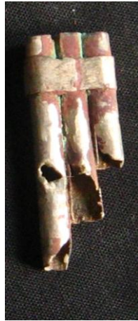
Detalle de la litera. Se puede observar los puntos de corrosión activa, cuprita.
