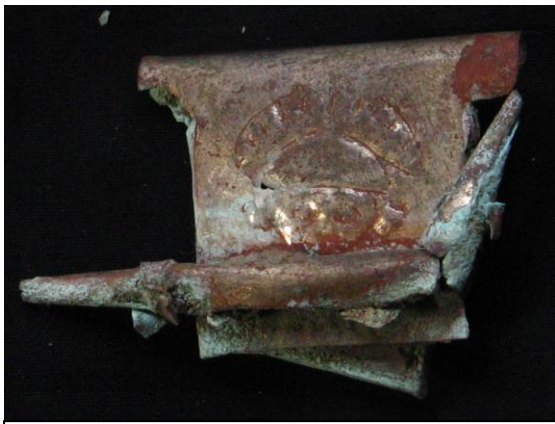
Detalle de la litera. Se puede observar los puntos de corrosión activa, cuprita.
