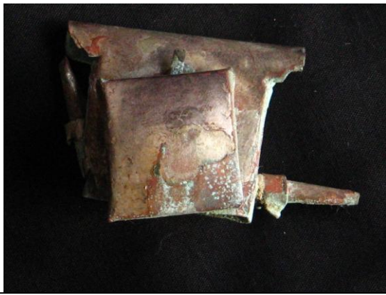
Detalle de la litera. Se puede observar los puntos de corrosión activa, cuprita.
