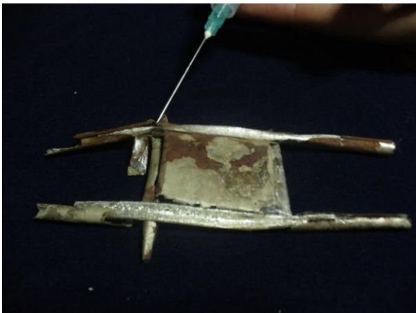
Consolidación con polaroid al 3%
