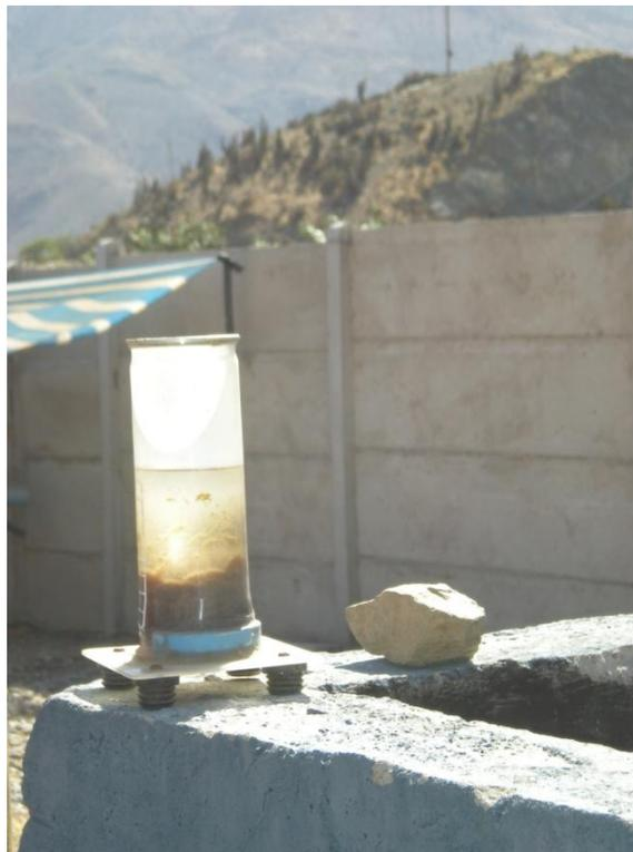
**Figura C.2 :** Probeta para análisis de volumen de lodo sedimentado
