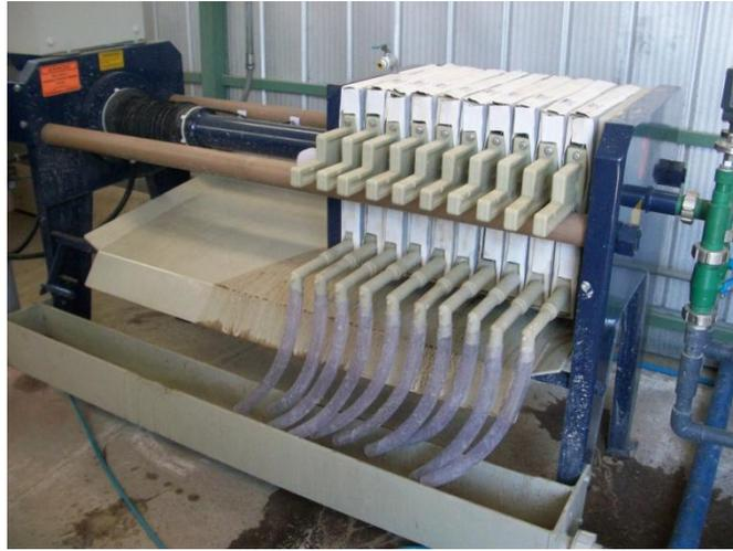
**Figura C.10:** Filtro de Prensa planta de tratamiento Larmahue
