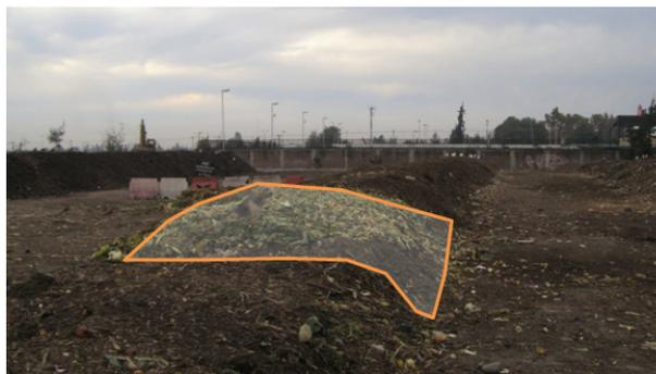
(4 x 3 x 1,5) = **18 m<sup>3</sup>** → Pila de Compost → **6 Ton**
