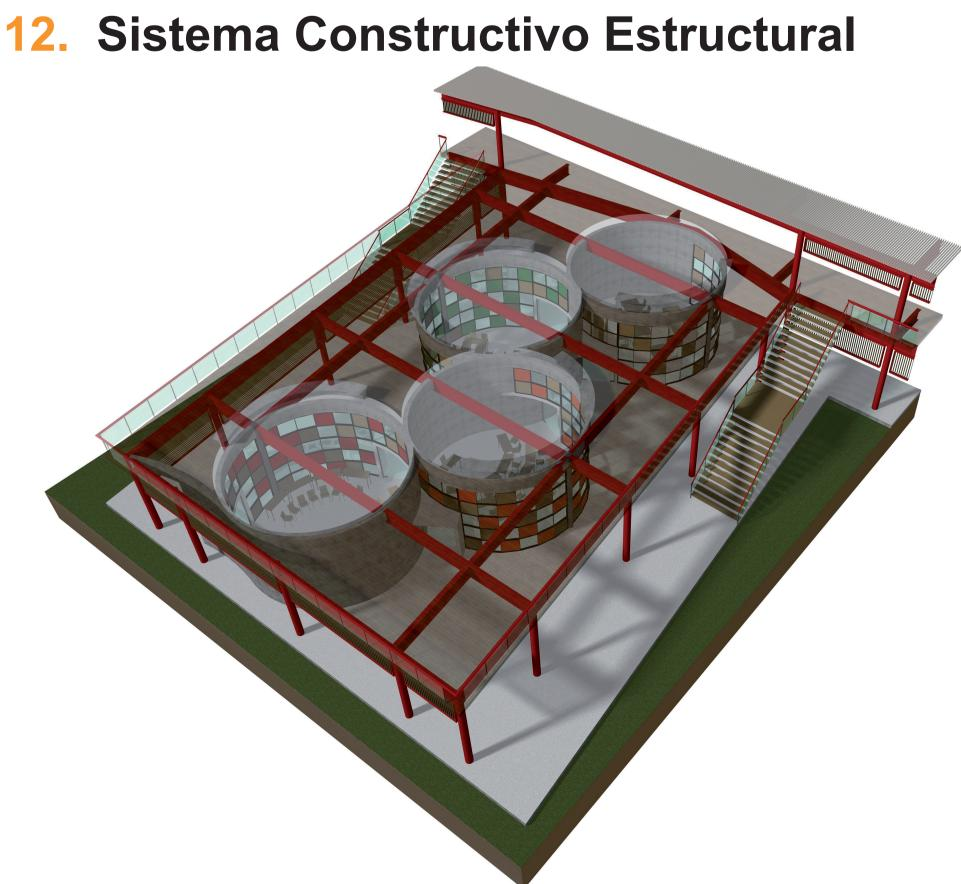
Se propone un partido constructivo general conformado de un muro ondulado de albañilería o hormigón armado, que actúa como eje estructural dispuesto en el centro de los bloques, para generar la especialidad de las distintas aulas y talleres, sumado una red ortogonal de vigas y principales pilares que sostienen las cubiertas habitables, complementada con vigas secundarias sostienen los cerramientos livianos que configuran los recintos.
