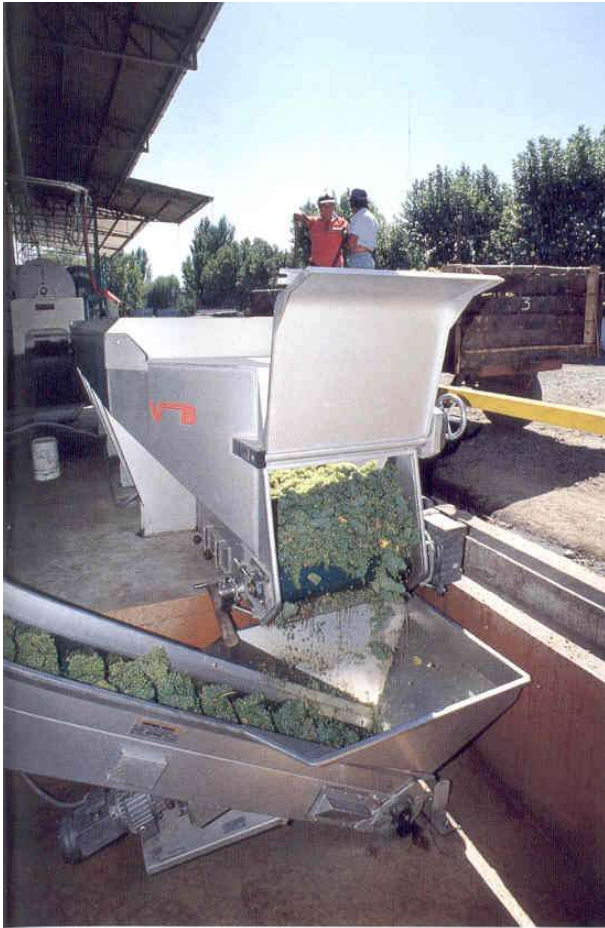
pozo de recepción - despalilladora
