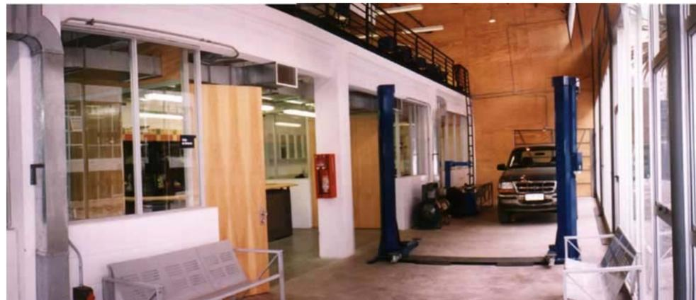
**Derecha:** Grúa eléctrica. Elemento esencial en los talleres de mecánica modernos que reemplaza el tradicional foso ya que este se encuentra obsoleto por peligro de intoxicación con gases CO. La grúa eléctrica levanta el automóvil a la altura que se desea, facilitando el trabajo del mecánico que se mantiene a nivel de suelo. Foto: Tomas Grau 2003
