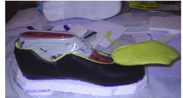
Casi terminada; montada doble la suela; esperando el secado del pegameto.
