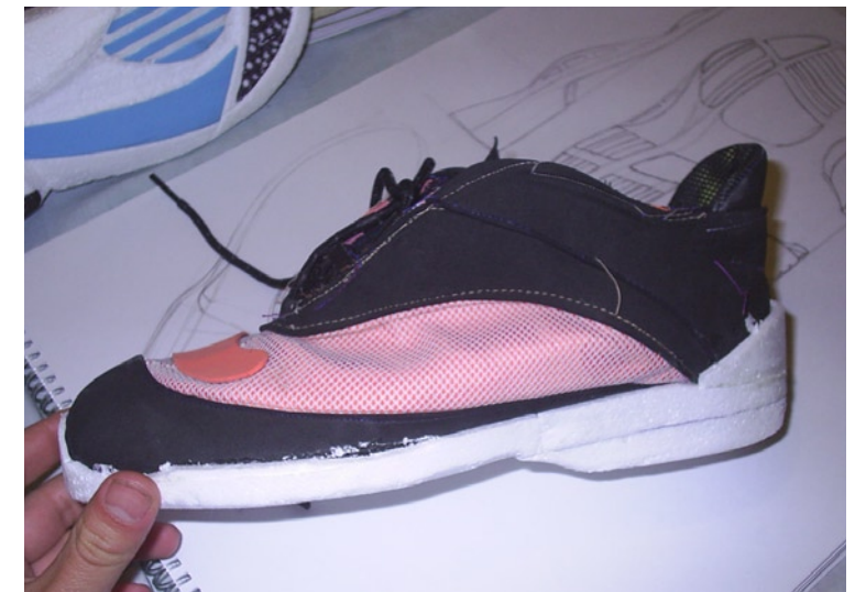
▲ Pala aparada parcialmente; nótese que al ser tela la doble curvatura debe iniciarse al momento de aparar.
