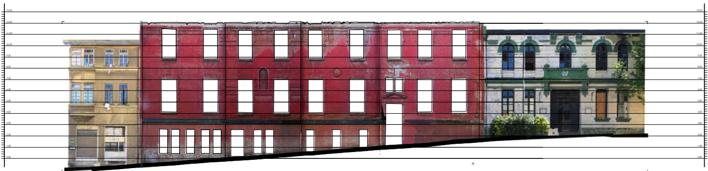
Elevación de la Calle Severín / Técnica Fotogramétrica Edificio antes del 1º incendio
