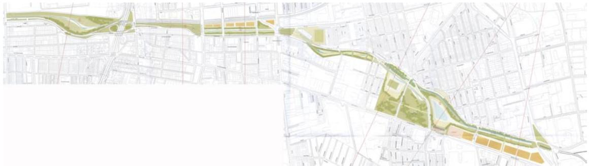
Toda esta intervención logra además consolidar el Zanjón de la Aguada como el canal mátriz de evacuación de aguas lluvias, el cual drena aproximadamente el 65 % de la superficie del Gran Santiago, además de resolver los desbordes históricos y recurrentes, ampliando su capacidad hidráulica hasta para eventos meteorológicos de un periodo de retorno de 100 años.
