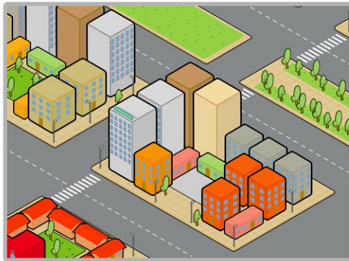
Figura 27, Imagen de un plano isométrico. En este no se generan distorsiones en las formas a pesar de estar en perspectiva.
