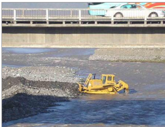
□□□□□□□□□□(Orientación SW). Lecho menor del Río Maipo a la altura del sector de San León, Comuna de San Bernardo. En el lugar, se explota un área concesionada a la “Constructora y comercializadora Fresno S.A.” Las faenas de extracción se ejecutan mediante dos retroexcavadoras que retiran una capa superficial de material integral. Octubre del 2005. (Foto Miguel A. Venegas). □□□□□□□□□□(Orientación WSW). Cauce habitual del Río Maipo a la altura del Puente homónimo (Ruta 5 Sur). En esta sección del cauce un bulldozer del Ministerio de Obras Públicas, modifica el escurrimiento incrementado por los deshielos para la protección de los pilares del viaducto. Octubre del 2005. (Foto Miguel A. Venegas).
