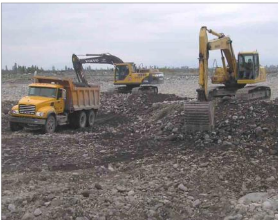
□□□□□□□□□□(Orientación SW). Lecho menor del Río Maipo a la altura del sector de San León, Comuna de San Bernardo. En el lugar, se explota un área concesionada a la “Constructora y comercializadora Fresno S.A.” Las faenas de extracción se ejecutan mediante dos retroexcavadoras que retiran una capa superficial de material integral. Octubre del 2005. (Foto Miguel A. Venegas). □□□□□□□□□□(Orientación WSW). Cauce habitual del Río Maipo a la altura del Puente homónimo (Ruta 5 Sur). En esta sección del cauce un bulldozer del Ministerio de Obras Públicas, modifica el escurrimiento incrementado por los deshielos para la protección de los pilares del viaducto. Octubre del 2005. (Foto Miguel A. Venegas).
