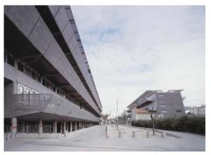
Los departamentos son sustentados mediante el empleo de una estructura de acero que sostiene los muros y las losas de hormigón. El revestimiento de aluminio exterior se monta aparentemente sobre una estructura menor.
